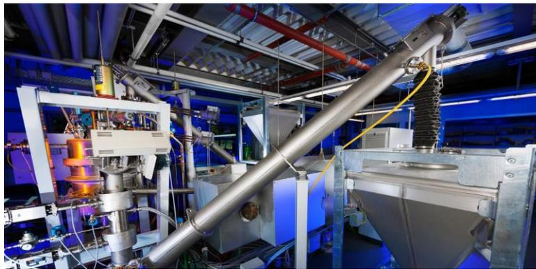
Abbildung 3: Thermochemische Energiespeicherung – Calciumhydroxid-System (Quelle: DLR)
